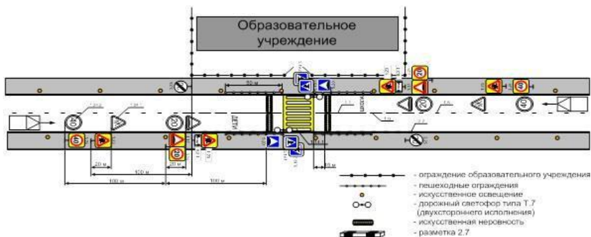
Рис.3 Пример нанесения дорожной разметки
