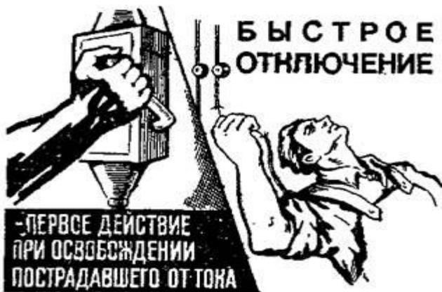
Рис. 2. Освобождение пострадавшего от действия электрического тока путем отключения электроустановки
