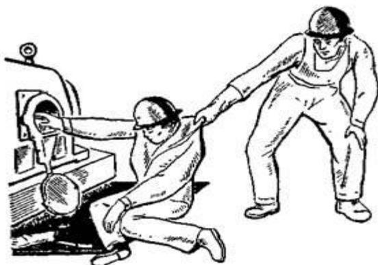
Рис. 4. Освобождение пострадавшего от действия электрического тока в установках низкого напряжения
