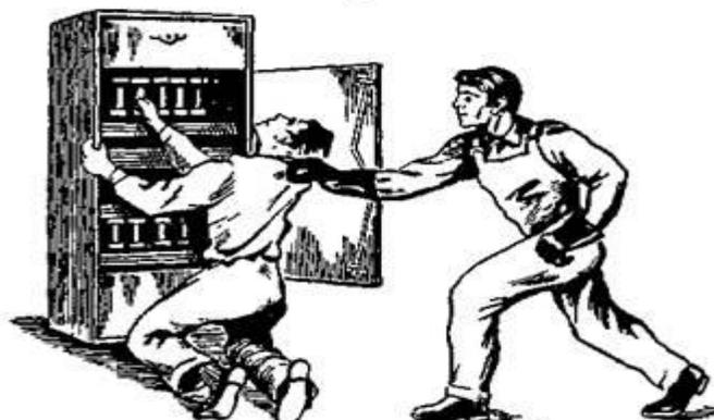
Рис. 5. Освобождение пострадавшего от токоведущей части, находящейся под напряжением до 1000 В
