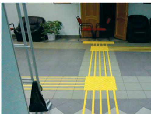
Рисунок 1.26. Пример использования тактильных лент в сочетании с тактильными плитами
