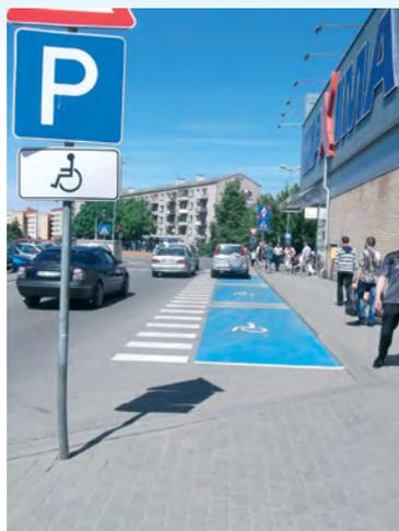
Рисунок 1.31. Пример размещения парковочного места для инвалидов параллельно оси движения в карманах небольшой глубины.
