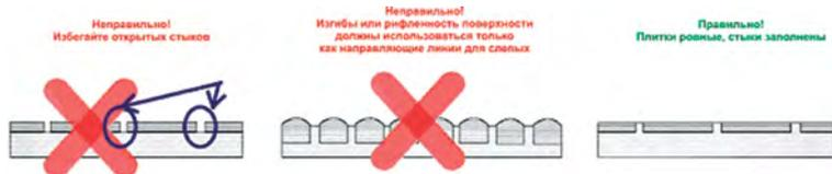
Рисунок 1.8. Неправильная и правильная формы поверхности покрытия.
