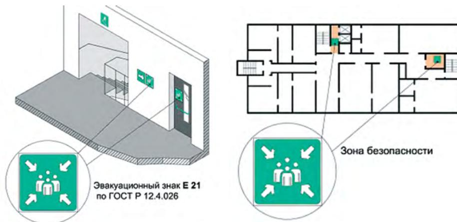
Рисунок 3.14. Пример размещения знака «Зона безопасности».
