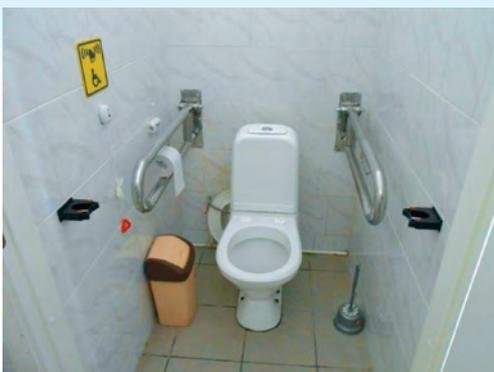
*Рисунок 5.10. Стандартная туалетная комната, оснащённая поручнями, кнопкой экстренной связи и держателями для тростей.*
