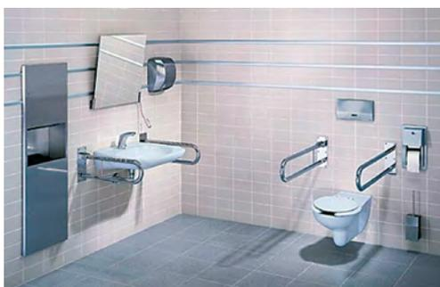
*Рисунок 5.8. Унитаз установлен посередине туалетной комнаты консольно и оснащён откидными поручнями с возможностью подъезда с обеих сторон.*
