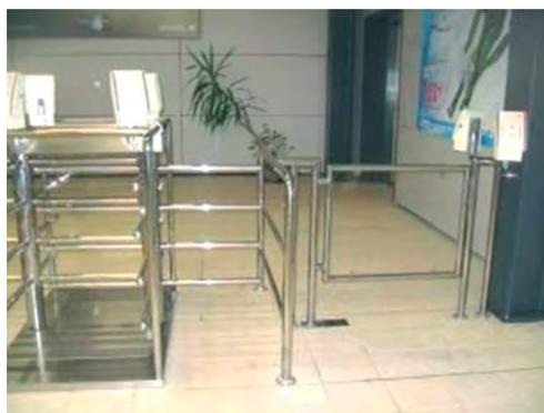
Рисунок 2.8. Калитки для проезда на кресле-коляске и прохода других МГН.
