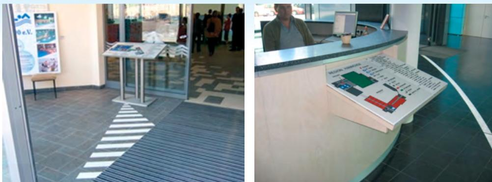
Рисунок 6.25. Трибуны с мнемосхемами. Подходы к трибунам снабжены тактильными указателями.
