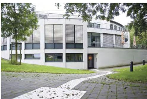
Рисунок 2.10. Пример применения тактильных указателей у входа в здание.
