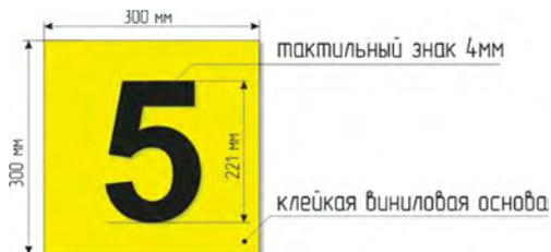
Рисунок 6.34. Тактильные номера на самоклеющейся виниловой пленке.
