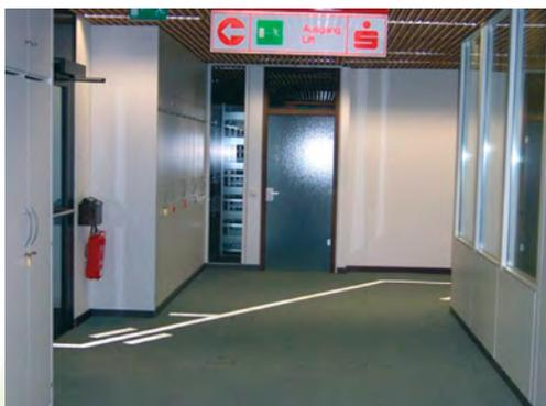
Рисунок 3.13. Пример обозначения путей эвакуации (Германия).
