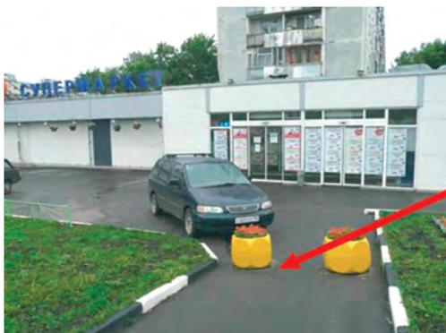
Рис. 1.5. Ширина пути движения должна быть не менее 1,2 м. Здесь проход между цветочницами 0,6м, инвалид на кресле-коляске не проедет.
